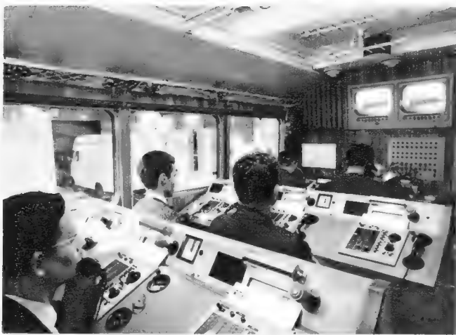
Bild 11. Blick in den Tonaussteuerungsteil des Eurovisions-Wagens im Studio B. Hier waren zehn Überwachungsplätze eingerichtet und besetzt
