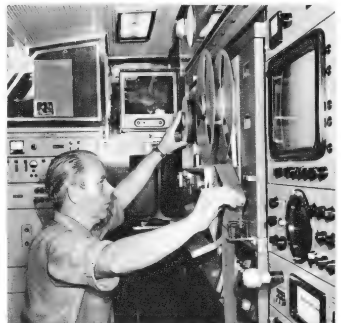
Bild 10. Blick in den Magnet-Bildaufzeichnungswagen 2 im Studio B mit einer für 525 Zeilen umgebauten Ampex-Anlage
